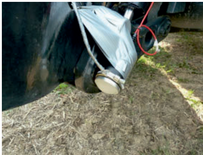
Sensore radar doppler GMH Engineering Delta DRS1000 per la rilevazione della velocità
