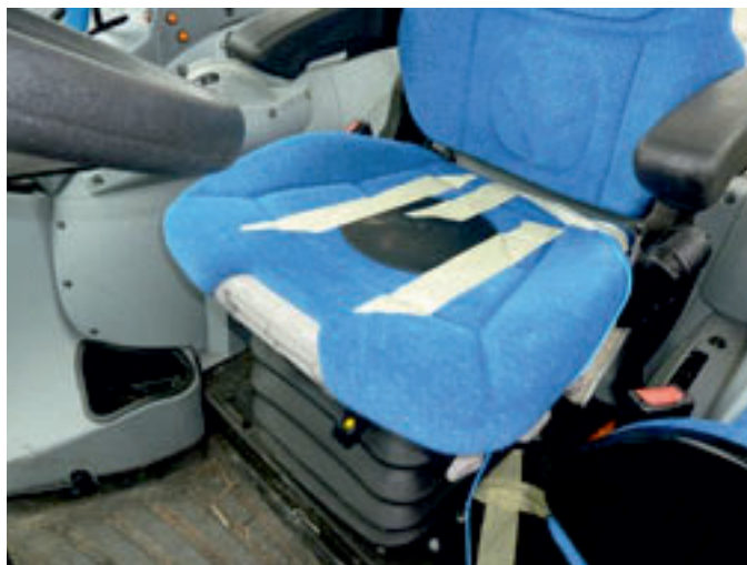
Accelerometro triassiale (inserito in un piatto semirigido di gomma) PCB Piezotronics SEN 027-356B40 sul piano del sedile
