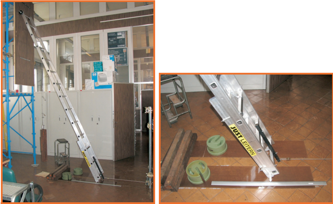
Figura 4.2.1-3 Scala con tronchetto, ruotino in sommità, superficie di prova in HPL e tiro alla base
