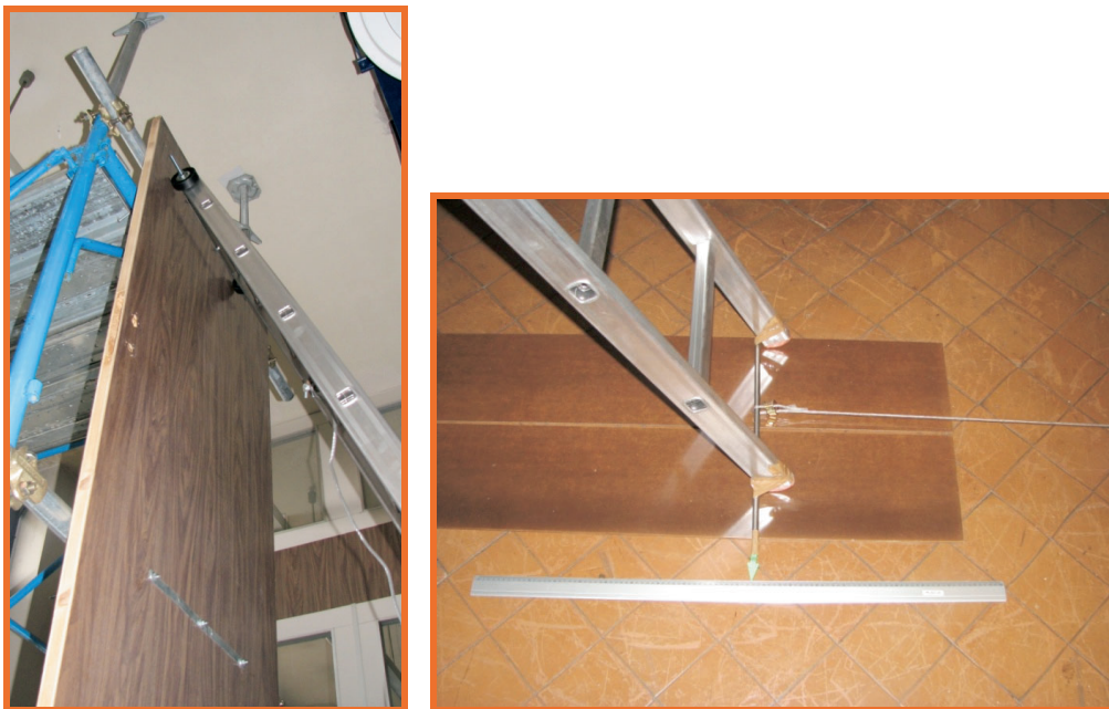
Figura 4.2.1-4 Particolare del ruotino in sommità e del sistema di misurazione della distanza di scivolamento
