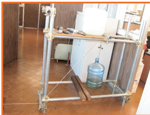
Figura 4.2.1-2 Scala a tronco unico, superficie alla base in HPL e tiro alla base
