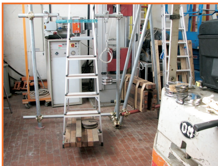
Figura 4.3 - 1 Prova di instabilità laterale su scala doppia
