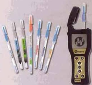
Bioluminometro per il controllo delle superfici e delle acque di risciacquo
