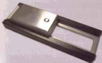
Bassuometro per la misurazione del livello di polvere sulle superfici
